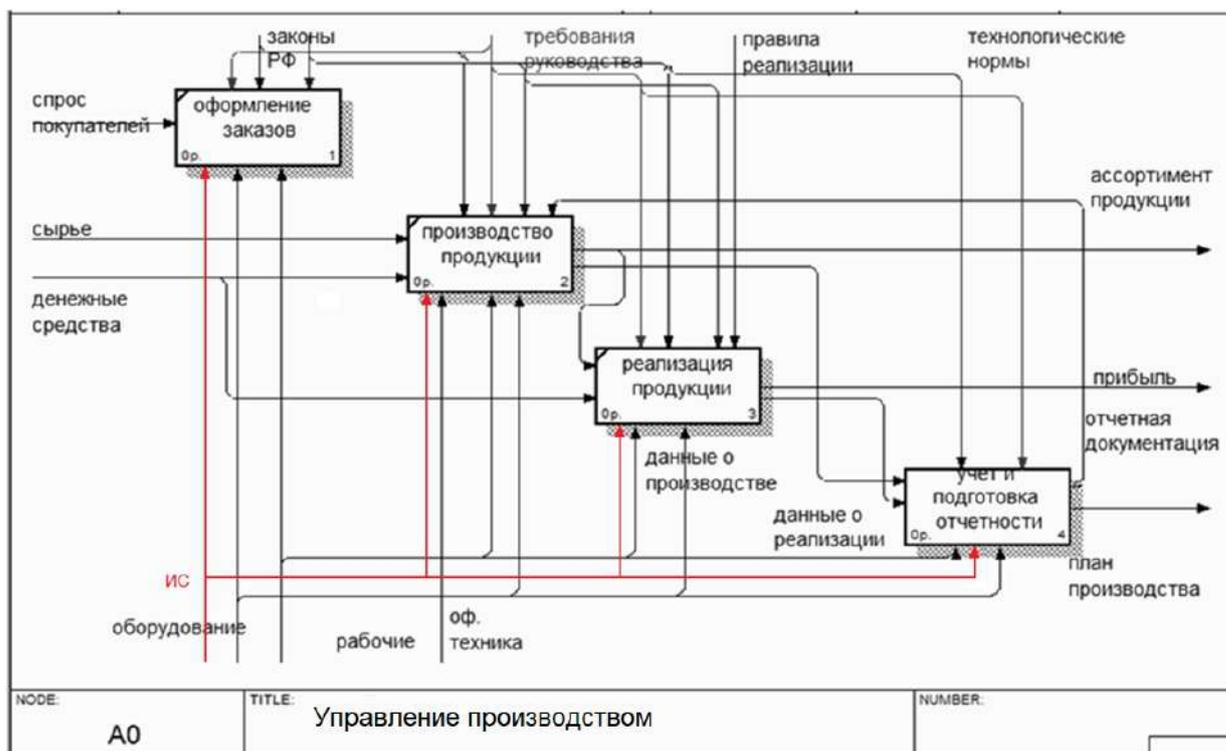
Рисунок 9. Контекстная диаграмма процесса управления производством КАК
